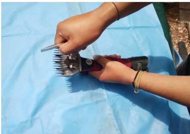
Cambiamos el peine afilado y presionamos ligeramente con las tuercas de sujeción del peine.
