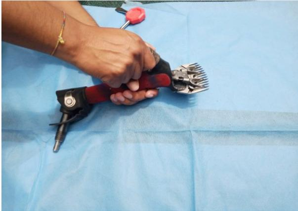
Apretamos levemente la tuerca del cabezal, verificamos el recorrido del cortante sobre el peine, para lo cual hacemos girar el engranaje del eje de la cola del galgo, y esta tiene que llegar de extremo a extremo en su totalidad.
