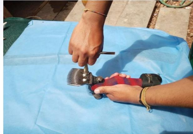
Una vez hecho la verificación realizamos el ajuste de los pernos de sujeción del peine sobre la rodilla o en una mesa.
