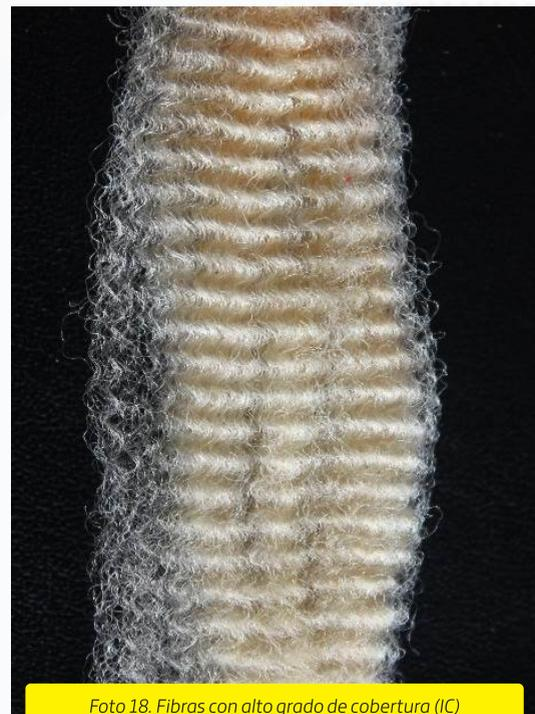
Foto 18. Fibras con alto grado de cobertura (IC)
