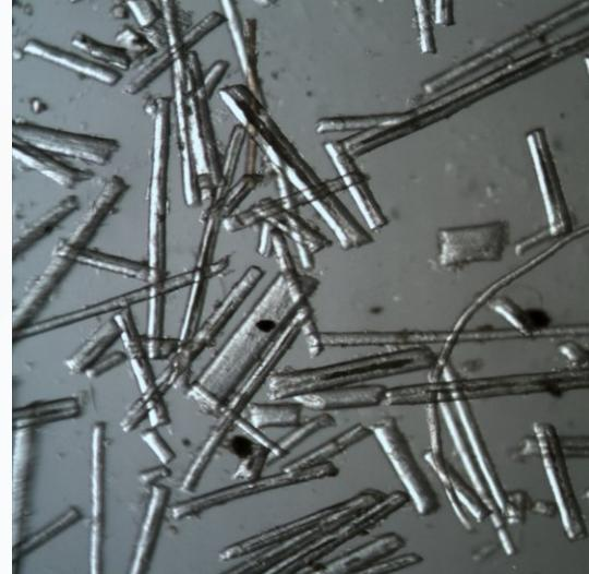
Foto 16. Muestra de fibras con coeficiente de variación alto
